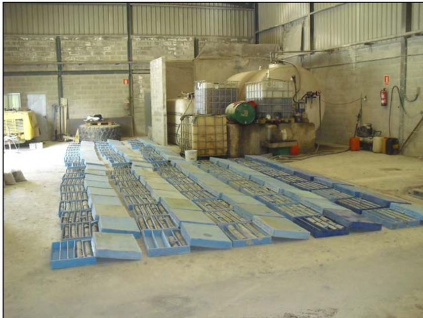
*Foto 1: Testificación de la campaña de sondeos en las instalaciones de la Cantera Ungo Nava-Vivanco.*
